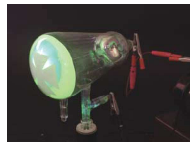
Sombra producida por rayos catódicos y un obstáculo con forma de cruz en un tubo de descarga.
